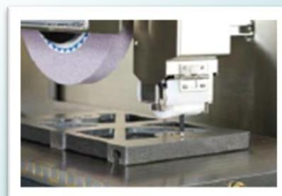
チャック上面にワークを置いたまま機械で寸法を計測、
